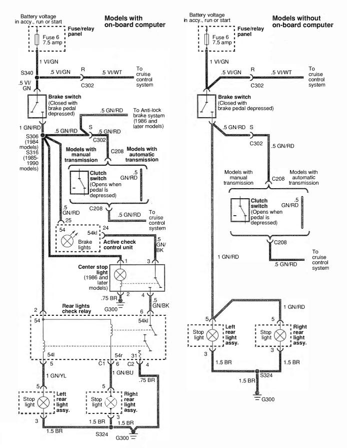
Fig. 10-9. Brake light circuits.
