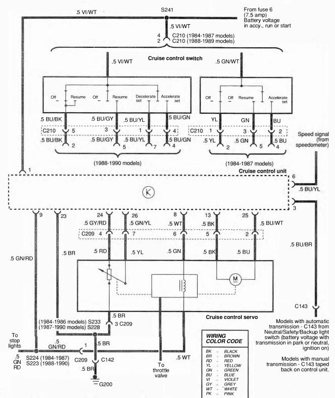
Fig. 12-9. Cruise control circuit.
